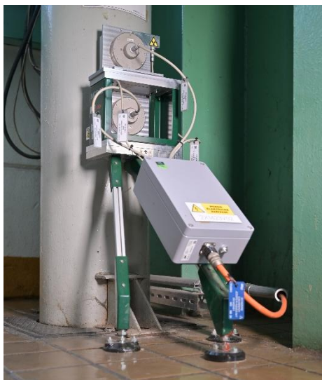
Detektor NGD-15 osazený na potrubí
