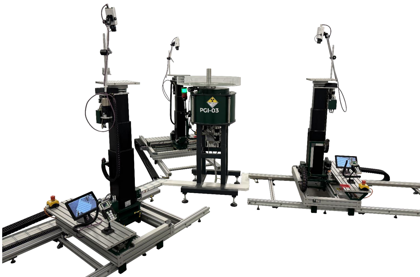
Ozařovač PGI-03 s otočným stolem dozimetrů a třemi kalibračními lavicemi CB-60
