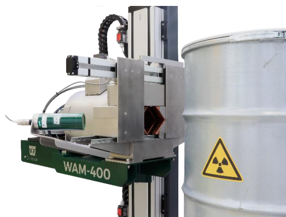
Kolimátor s pootevřenou štěrbinou a gama sonda MDG-12S pro funkci Fast-Scan
