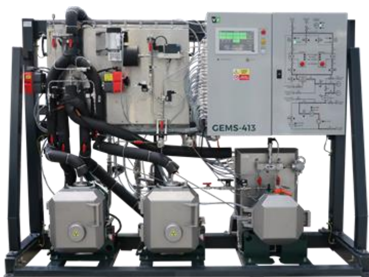
Systém monitorování a vzorkování plyných výpustí za havarijního provozu GEMS-413
