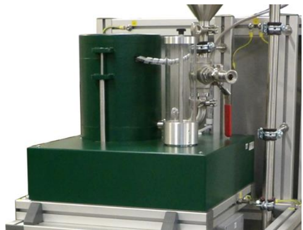
Detail detektoru se zásobníkem na jódové patrony
