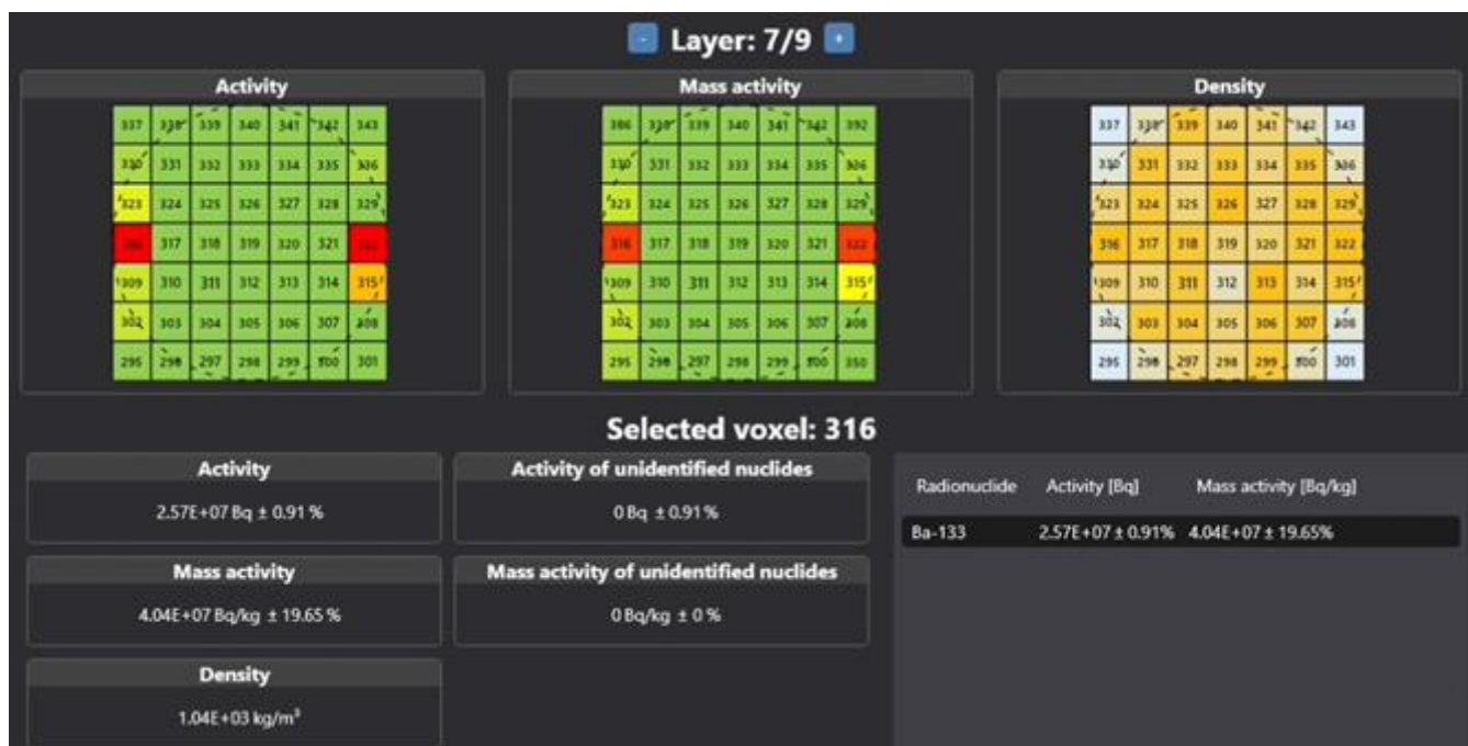
WAM-400: Tomografické rozložení aktivit a hustoty ve zvolené vrstvě sudu
