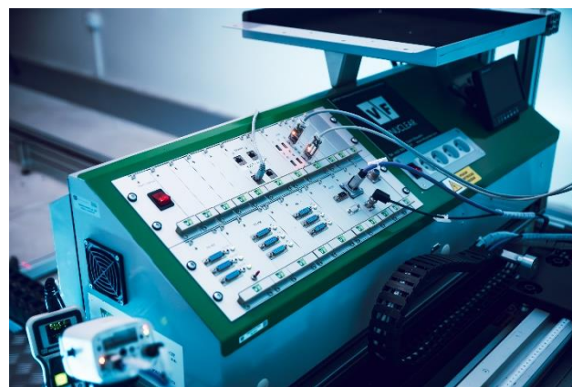
Panel automatického odečtu dat z měřidel
