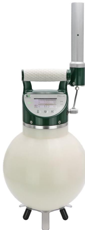
PNM-02 se sondou SGD-01e pro měření příkonu dávkového ekvivalentu gama (měřící poloha)
